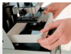
Sistema MAGNAVAT. Cambio rápido de cubeta.
